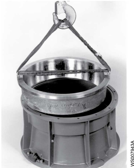
Рис. 32: Установка компенсационного кольца на выпускной конус
