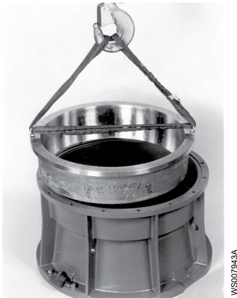
Рис. 32: Установка компенсационного кольца на выпускной конус
