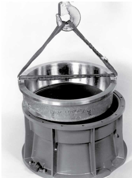
Рис. 39: Снятие компенсационного кольца с выпускного конуса
