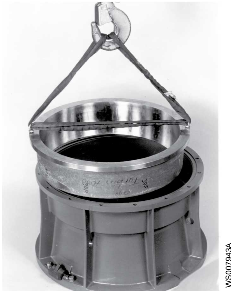
Рис. 40: Установка компенсационного кольца на выпускной конус
