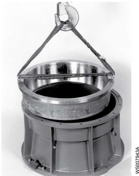
Рис. 36: Снятие компенсационного кольца с выпускного конуса
