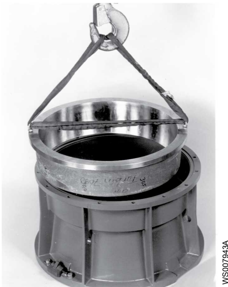
Рис. 40: Установка компенсационного кольца на выпускной конус
