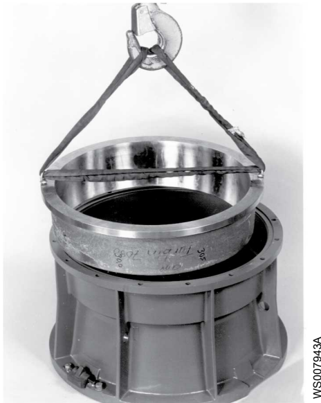
Рис. 21: Снятие компенсационного кольца с выпускного конуса
