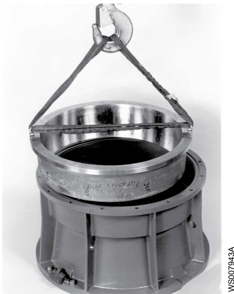
Рис. 22: Установка компенсационного кольца на выпускной конус
