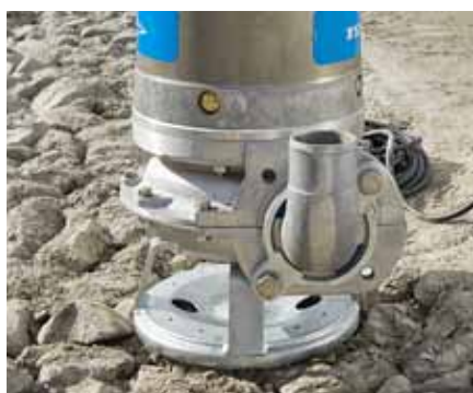
Более крупное впускное отверстие, улитка и боковая линия нагнетания Перекачивает твердые частицы диаметром до 80 мм (3,2 дюйма) и концентрацией около 20% по весу.
