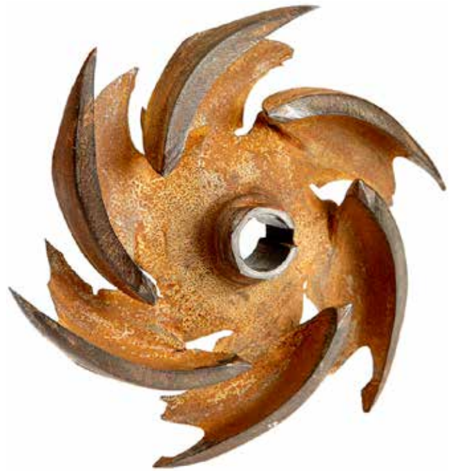
Робоче колесо після тесту в лабораторії. Тест "прискорене зношування"
